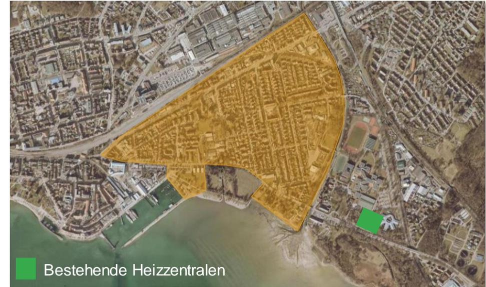
**Ziel:** Ausbau der bestehenden Wärmeversorgung aus dem Berufsschulzentrum durch die Nutzung von Abwasser aus dem Klärwerk. Erweiterung des Wärmenetzes Richtung Innenstadt mit Nutzung von Seethermie (M1) aus Standort „Hinterer Hafen“.
